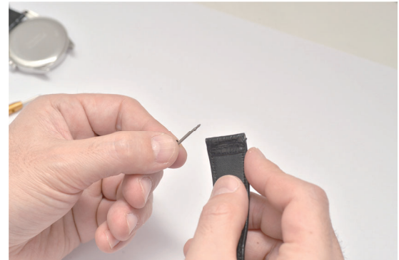
④取り外したベルトについているバネ棒を取り外します。
