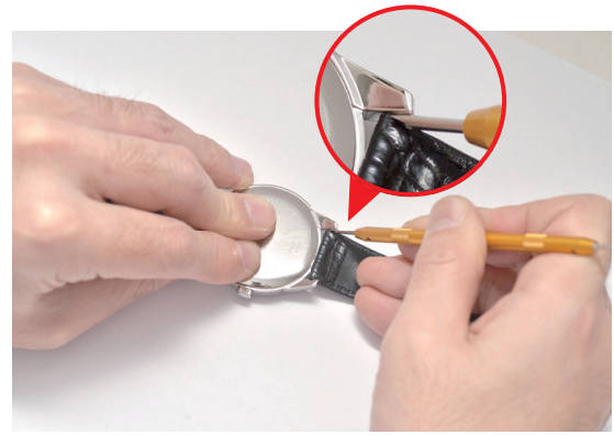
②バネ棒の溝に引っ掛けてバネ棒を押し上げます。
