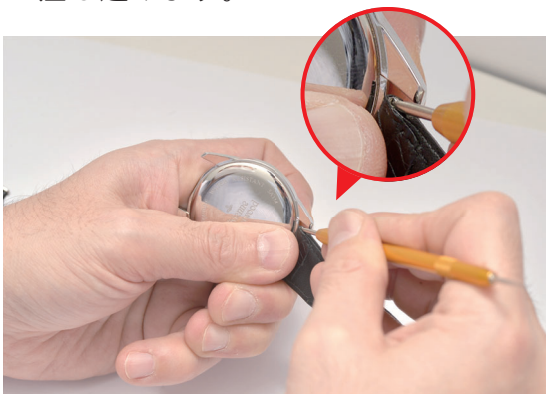
⑦バネ棒はずしを使ってバネ棒はずしを押し下げます。
