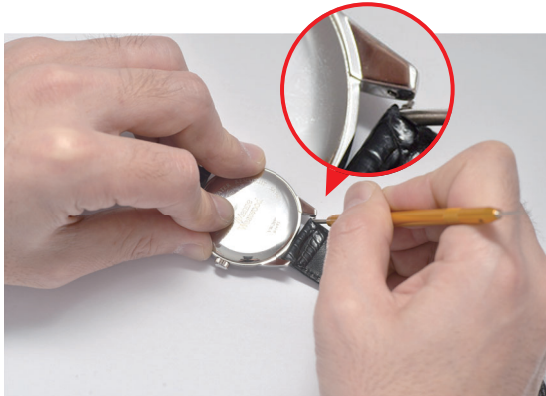
③バネ棒を押し下げたまま、バネ棒はずしの先端を手前に引くようにすると外れます。
