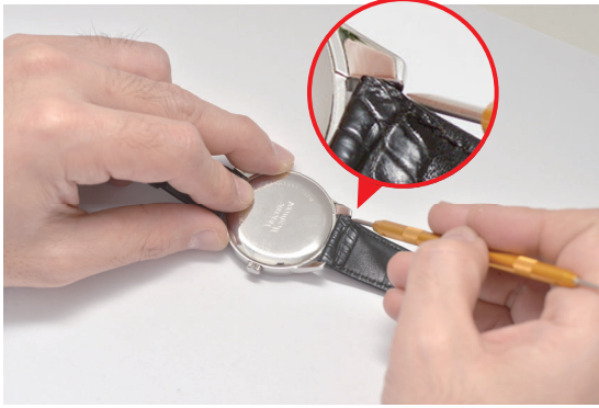
①時計ケースのラグ部分とベルトの隙間にバネ棒はずしを差し込みます。
